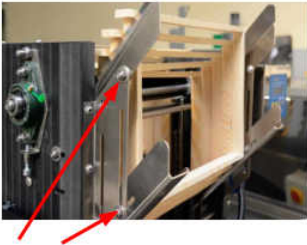
Abb. 13 Einstellung der oberen und unteren Führung und korrekte Positionierung der Rähmchen in den Führungen
