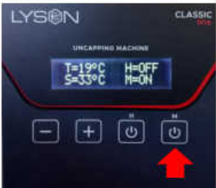
Abb. 9 Die Entdeckelungsmesser mit Taste Nr. 4 ON/OFF einschalten.
