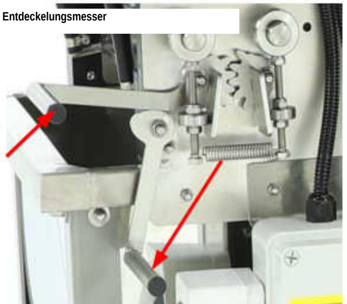
Abb. 17 Die korrekte Einstellung der Messer-Arbeitsbreite ermöglicht den optimalen Betrieb der Maschine und das korrekte Entdeckeln der Wabenoberfläche.
