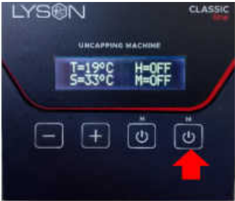
Abb. 10 Die Entdeckelungsmesser mit Taste Nr. 4 ON/OFF ausschalten.
