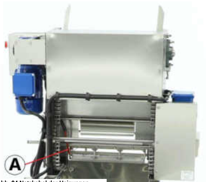
Abb. 24 Netzkabel der Heizungen
