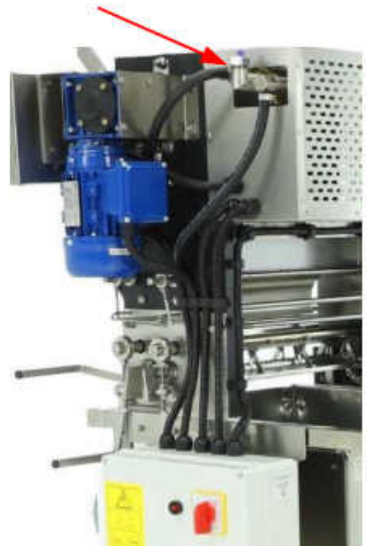
Abb. 21 Lage der Einfüllöffnung
