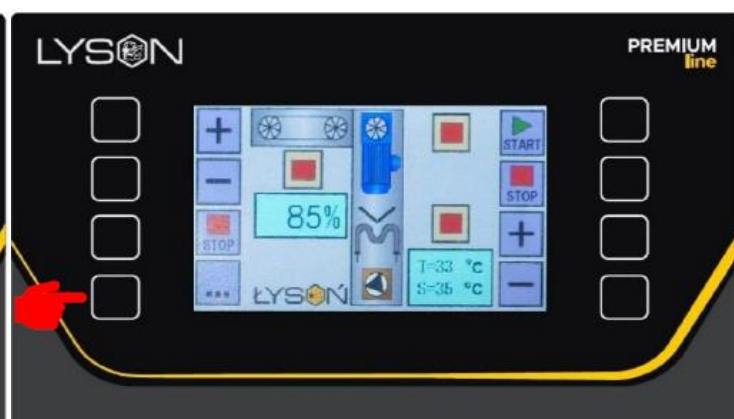
Abb. 5.2.1. Bedienfeld vor dem Aufruf des Menüs Die Geschwindigkeit des Trenn-Pressmoduls der Entdeckelungsmaschine wird mit den Tasten Nr. 1 - „PLUS“ zum Erhöhen bzw. Nr. 2 - „MINUS“ zum Verringern des Parameterwerts geändert (siehe Abb. 5.2.3.).
