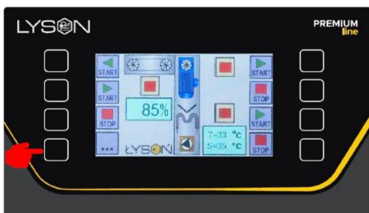
Abb. 5.2.1. Bedienfeld vor dem Aufruf des Menüs Die Geschwindigkeit des Trenn-Pressmoduls der Entdeckelungsmaschine wird mit den Tasten Nr. 1 - „PLUS“ zum Erhöhen bzw. Nr. 2 - „MINUS“ zum Verringern des Parameterwerts geändert (siehe Abb. 5.2.3.).
