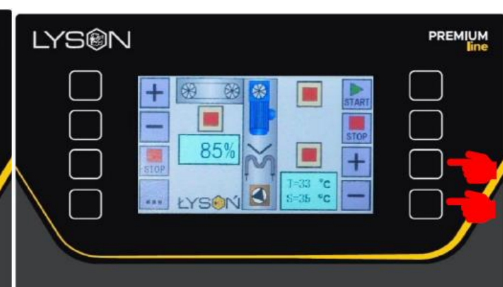
Abb. 5.2.3. Ändern der Modulgeschwindigkeit (Parameter S) Einstellen der Messertemperatur, Parameter S. Die Temperatur wird mit Taste Nr. 7 - „PLUS“ zum Erhöhen und Taste Nr. 8 - „MINUS“ zum Verringern des Parameterwerts eingestellt (siehe Abb. 5.2.4.). Erneutes Drücken der Taste Nr. 4 - „[...]“ verlässt das Menü. Die Aktivierung einzelner Maschinenkomponenten wird durch eine animierte Grafik auf dem Display angezeigt.
