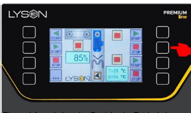
Abb. 5.2.7. Einschalten der Entdeckungsmesser - Taste Nr. 5 Ein- und Ausschalten des Betriebs der Entdeckungsmaschine (siehe Abb. 5.2.9. und Abb. 5.2.10.). Abb. 5.2.8. Ausschalten der Messer - Taste Nr. 6
