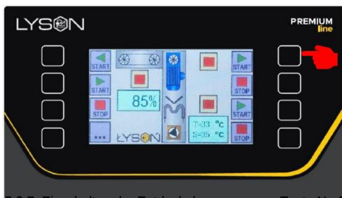
Abb. 5.2.7. Einschalten der Entdeckungsmesser - Taste Nr. 5 Ein- und Ausschalten des Betriebs der Entdeckungsmaschine (siehe Abb. 5.2.9. und Abb. 5.2.10.). Abb. 5.2.8. Ausschalten der Messer - Taste Nr. 6
