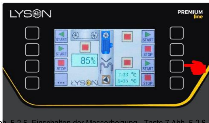
Abb. 5.2.5. Einschalten der Messerheizung - Taste 7 Abb. 5.2.6. Ausschalten der Messerheizung - Taste 8 Anschließend die Entdeckungsmesser einschalten (siehe Abb. 5.2.7.) bzw. die Arbeit der Messer stoppen (siehe Abb. 5.2.8.).
