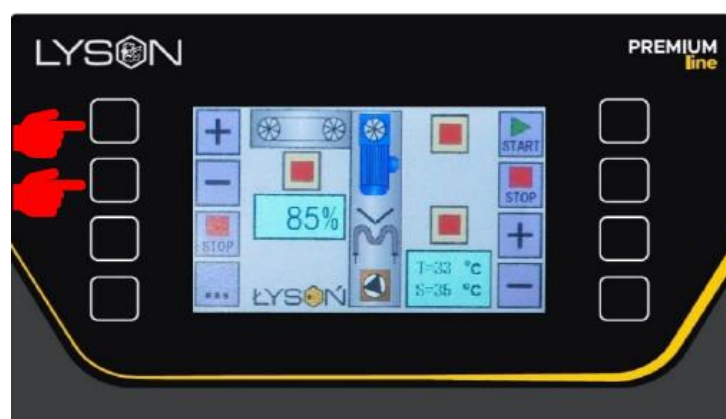
Abb. 5.2.3. Ändern der Modulgeschwindigkeit (Parameter S) Einstellen der Messertemperatur, Parameter S. Die Temperatur wird mit Taste Nr. 7 - „PLUS“ zum Erhöhen und Taste Nr. 8 - „MINUS“ zum Verringern des Parameterwerts eingestellt (siehe Abb. 5.2.4.). Erneutes Drücken der Taste Nr. 4 - „[...]“ verlässt das Menü. Die Aktivierung einzelner Maschinenkomponenten wird durch eine animierte Grafik auf dem Display angezeigt.
