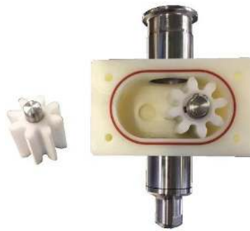
Schritt 4 – Dosiermodul aus dem Abfüllergehäuse entnehmen
