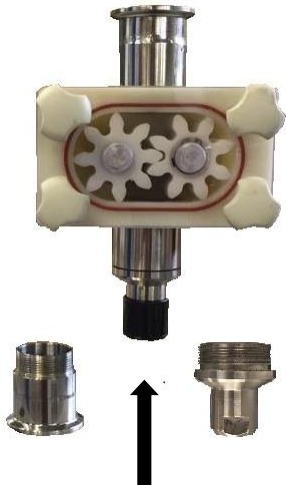
A – Cremigrühr-Düse, B – Dosierdüse zum Pumpen
