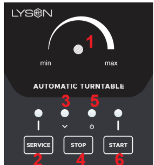
Abb. 7 Servicemodus Der Servicemodus (Taste 2, Abb. 2) dient nur zur Einstellung des Endschalters (Abb. 5), der den Tisch stoppt, wenn das Glas/die Flasche in der richtigen Position unter der Düse des Abfüllers steht. Nach dem Drücken der START-Taste des Servicemodus dreht sich der Tisch mit der am Drehzahlregler (Regler 1, Abb. 7) eingestellten Geschwindigkeit. Die Erkennung eines Glases in der Stopposition (Signal vom Endschalter, Abb. 5) stoppt die Tischbewegung für ca. 1 s. Danach wird die Bewegung fortgesetzt. Zum Verlassen des Servicemodus die STOP-Taste drücken (Taste 4, Abb. 7)
