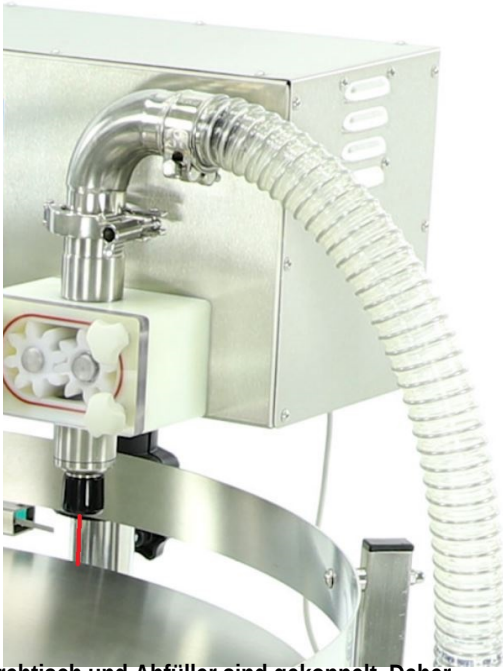
Abb. 5 Achtung: Drehtisch und Abfüller sind gekoppelt. Daher beim Glastest daran denken, den Abfüller mit der Taste „Service“ auszuschalten, wodurch der Abfüllbetrieb deaktiviert wird.
