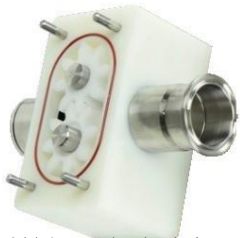
Abb. 6.8. Schritt 8. Das zweite Zahnrad aufsetzen mit der Welle
