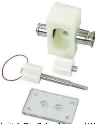
Abb. 6.4. Schritt 4. Die Zahnräder und Wellen entnehmen und alles gründlich waschen. Zum Trocknen liegen lassen
