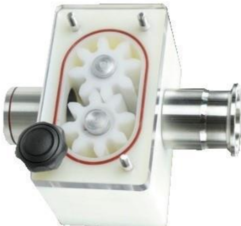
Abb. 6.1. Schritt 1. Die 4 Knebelschrauben lösen vom Zahnradmodul (an der Gerätevorderseite)
