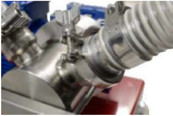
Korrekte Befestigung des Schlauchs am Rotor
