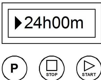
Abb. 2. Je nach vorherigen Einstellungen zeigt der Bildschirm die zuvor eingestellte Betriebszeit des Honigrührers an. Die Steuerung verfügt über mehrere Programme, mit denen die Gesamtrührzeit präzise von 24 bis 99 Stunden sowie 1 Stunde im Spezialzyklus (für Geräte auf Auftauschrank) gewählt werden kann. Die Bedienung beschränkt sich auf die Wahl eines Programms (durch Drücken der Taste „P“) und die anschließende Aktivierung des gewählten Programmzyklus mit der START-Taste. Zur Wahl der passenden Betriebszeit für den Honigrührer
