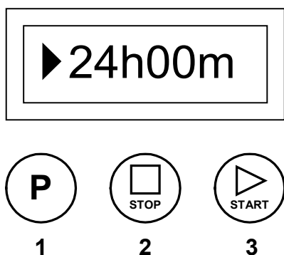
Abb. 1. Bedienfeld der Honigrührer-Steuerung 3.1. Tastenbeschreibung – Steuerungsfunktionen Nach dem Anschluss der Stromversorgung führt die Steuerung eine Selbstdiagnose durch, um den korrekten Gerätebetrieb zu bestätigen. Die Fehlererkennung wird durch den entsprechenden Code auf dem LCD-Bildschirm signalisiert
