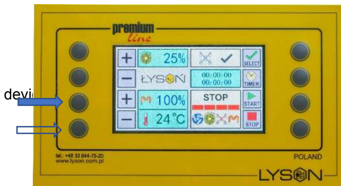
Foto 3: Einstellen der Heizleistung und Anzeige der aktuellen Temperatur im Gerät. Die Select-Taste ist bei diesem Gerät nicht belegt. Feld zum Aktivieren/Deaktivieren des Lufttrockners.
