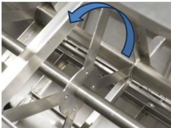
Abb. 6.7.7. Ausrichten des Korbs in die Beladeposition (Drehen des Korbs)
