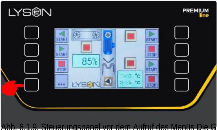
Abb. 6.1.9. Steuerungspanel vor dem Aufruf des Menüs Die Geschwindigkeit des Trenn- und Pressmoduls in der Entdeckelungsmaschine wird mit den Tasten Nr. 1 - „PLUS“ zum Erhöhen bzw. Nr. 2 - „MINUS“ zum Verringern des Parameterwerts geändert (siehe Abb. 6.1.11.).
