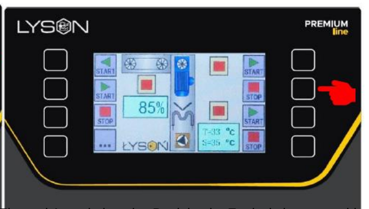
Abb. 6.1.15. Einschalten der Entdeckelungsmesser Taste Nr. 5 Ein- und Ausschalten des Betriebs der Entdeckelungsmaschine (siehe Abb. 6.1.17. und Abb. 6.1.18.).
