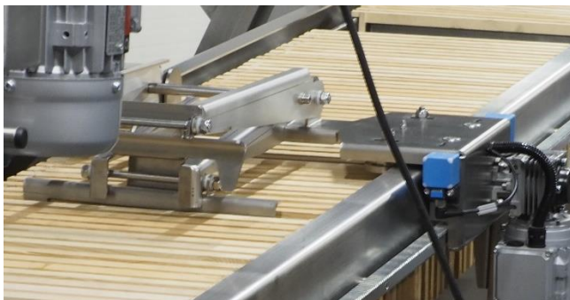
Abb. 6.7.5. Funktion des Rähmchenzubringers (PHASE 1)
