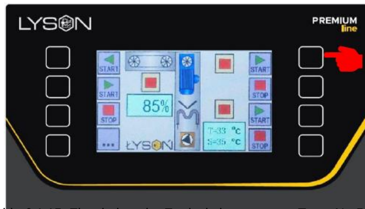
Abb. 6.1.15. Einschalten der Entdeckelungsmesser Taste Nr. 5 Ein- und Ausschalten des Betriebs der Entdeckelungsmaschine (siehe Abb. 6.1.17. und Abb. 6.1.18.).
