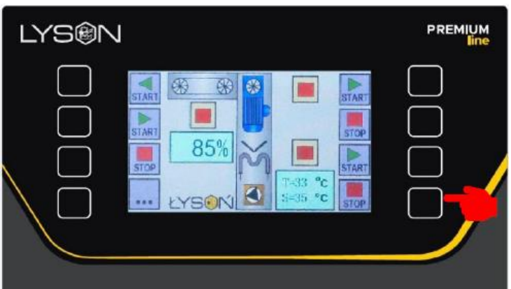
Abb. 6.1.13. Einschalten der Messerheizung - Taste 7 Abb. 6.1.14. Ausschalten der Messerheizung - Taste 8 Anschließend die Entdeckelungsmesser einschalten (siehe Abb. 6.1.15.) bzw. deren Betrieb stoppen (siehe Abb. 6.1.16.).
