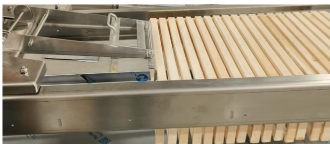
Abb. 6.7.9. Funktion des Rähmchenzubringers (PHASE 2)
