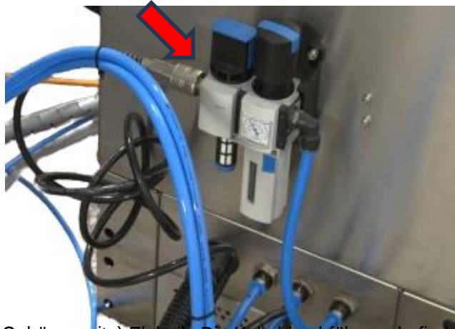
Abb. 5.2.1. Druckluftanschluss (linke Gehäusesseite) Elektrik: Die Kabeldurchführung befindet sich an der Rückwand des Steuerungsgehäuses (siehe Abb. 5.2.2.). Kein Netzkabel im Set enthalten. Das Netzkabel muss an die Klemmleiste im Inneren des Steuerungsgehäuses angeschlossen werden.
