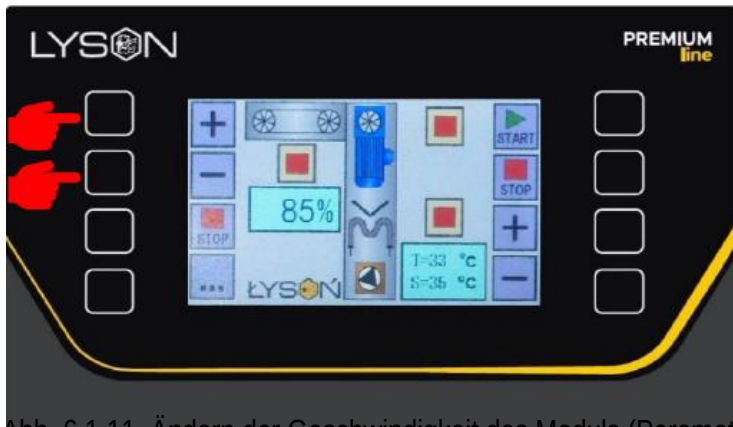
Abb. 6.1.11. Ändern der Geschwindigkeit des Moduls (Parameter S) Einstellen der Messertemperatur (Parameter S). Die Temperatur wird mit Taste Nr. 7 - „PLUS“ zum Erhöhen und Taste Nr. 8 - „MINUS“ zum Verringern des Messwertes eingestellt (siehe Abb. 6.1.12.). Erneutes Drücken der Taste Nr. 4 - „[...]“ verlässt das Menü. Die Aktivierung der einzelnen Maschinenkomponenten wird durch eine animierte Grafik auf dem Display angezeigt. Die eingestellte Temperatur wird von der Steuerung gehalten (einschließlich Messerheizung, siehe Abb. 6.1.13.). Sobald die Messer die eingestellte Temperatur erreicht haben, kann mit dem Entdeckeln begonnen werden (Ausschalten der Heizung siehe Abb. 6.1.14.).
