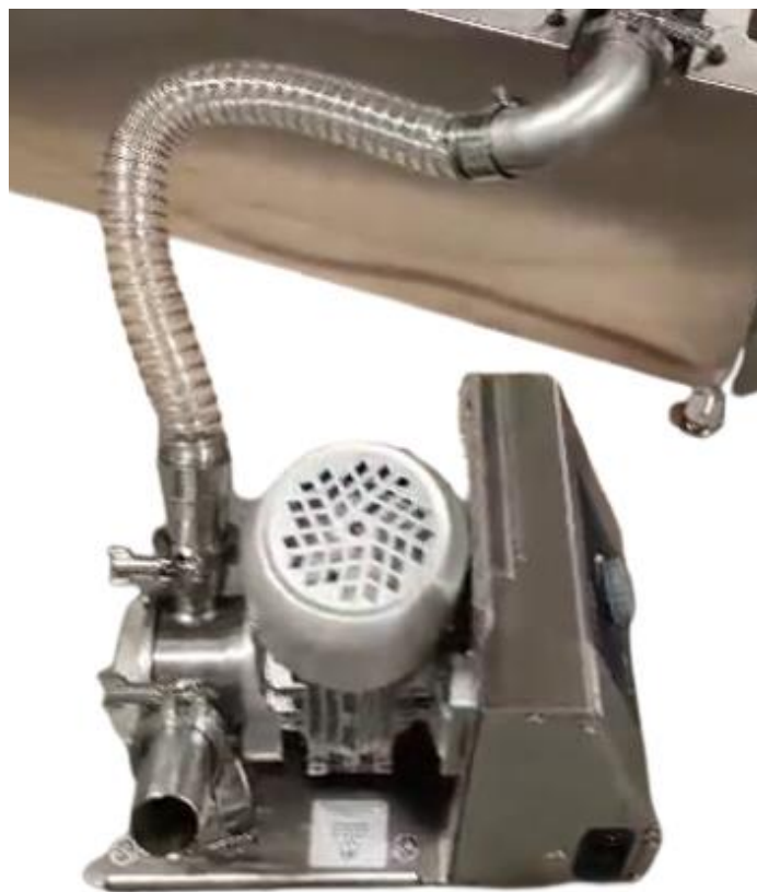
Abb. 5.1.11. Anschluss der Pumpe an den beheizten Klärbehälter (Saug- und Druckeinheit)
