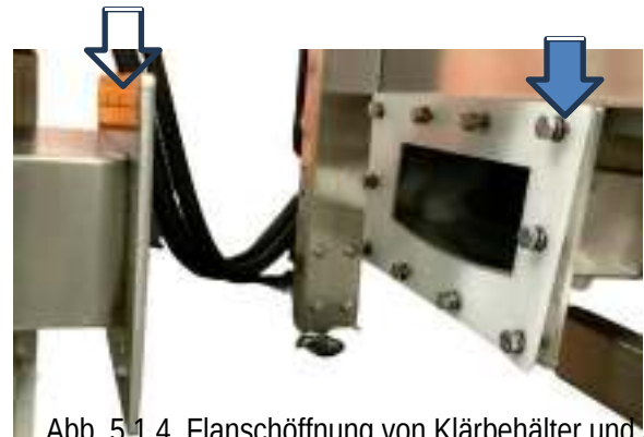
Abb. 5.1.4. Flanschöffnung von Klärbehälter und Schleuder
