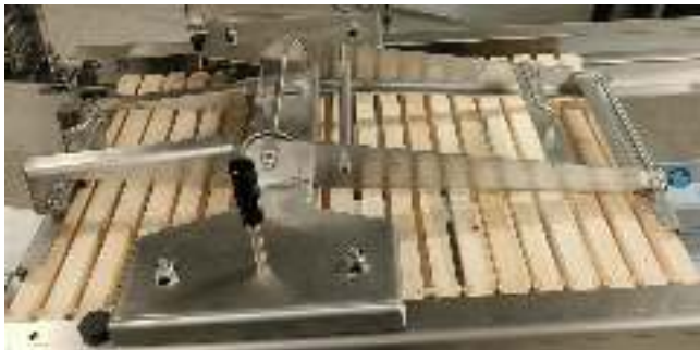
Abb. 6.7.3. Funktion des Rähmchenzubringers (PHASE 1)
