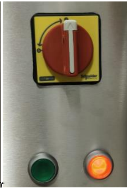
Abb. 6.2. Hauptschalter in Stellung „1“
