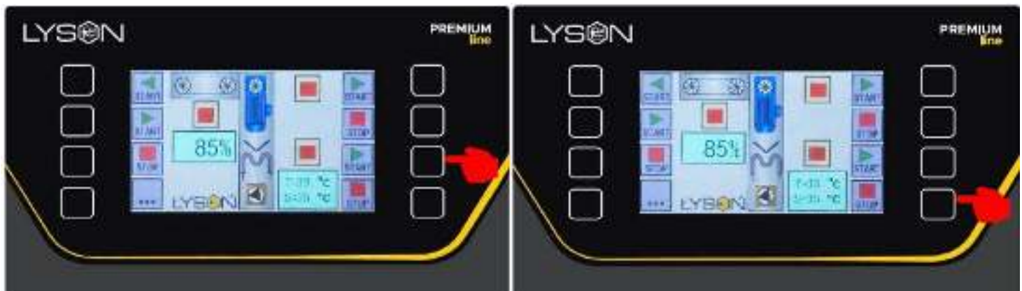
Abb. 6.1.13. Einschalten der Messerheizung – Taste 7 Abb. 6.1.14. Ausschalten der Messerheizung – Taste 8 Anschließend die Entdeckungsmesser einschalten (siehe Abb. 6.1.15.) bzw. deren Betrieb stoppen (siehe Abb. 6.1.16.).
