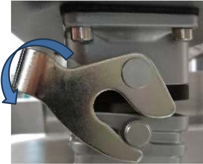
Abb. 5.2.7. Schritt 1 - einstecken/eindrücken, Verriegelung offen
