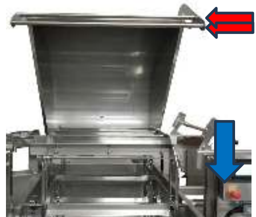
Abb. 6.7.4. Sicherheitstaster „STOP“ (blauer Pfeil) und Deckelgriffe
