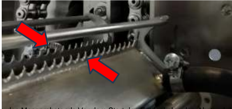
Abb. 6.1.1. Einstellung des Messerabstands Vor dem Start des Entdeckelns den Abstand der Messer an die Breite der Waben anpassen (siehe Abb. 6.1.1.). Dies gewährleistet ein optimales Entdeckeln des Rähmchens. Der Messerabstand wird mit zwei Hebeln eingestellt: Einstellhebel A und Feststellhebel B (siehe Abb. 6.1.2.). Korrekte Arbeitsrichtung
