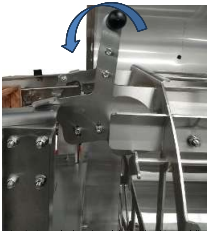
Abb. 6.7.7. Klinkenbewegung zum Entriegeln des Korbs (von der Zubringerseite - blauer Pfeil - nach links). Korb in Beladeposition, verriegelt
