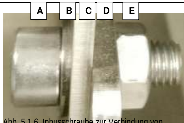
Abb. 5.1.6. Inbusschraube zur Verbindung von Entdeckelungsmaschine und Schleuder (von links: Inbusschraube - A + Scheibe - B + Platte der Entdeckelungsmaschine - C + Platte der Schleuder - D + Mutter - E)
